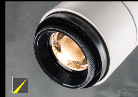
將調焦環右轉到底,透鏡前移即呈現窄角光束角
