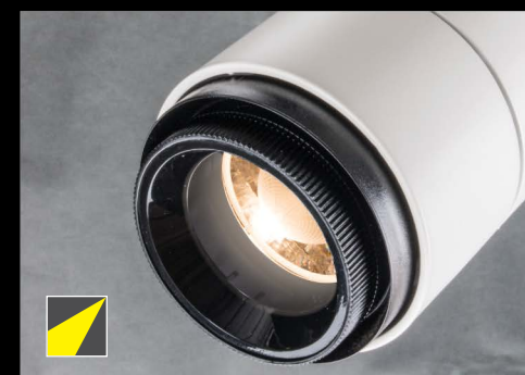
將調焦環左轉到底,透鏡後移即呈現廣角光束角
